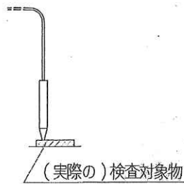
〈図69〉鉄筋探査器
